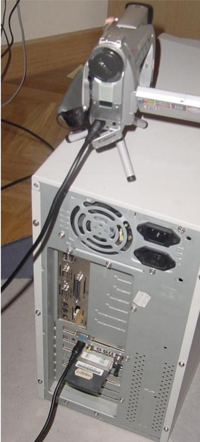
Ya tenemos montado todo a nivel de hardware pero necesitamos ahora dar soporte al controlador bt848 del núcleo de GNU/Linux y ver si realmente el sistema reconoce a la tarjeta. Vemos que en principio, está bien pinchada y es reconocida como un dispositivo PCI.
